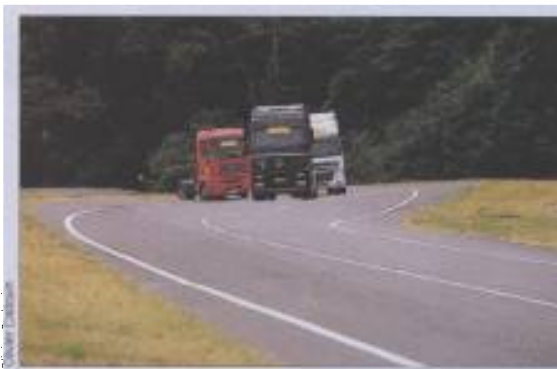
► Le système embarqué analyse le marquage au sol : impossible pour ces camions de quitter leur voie.
